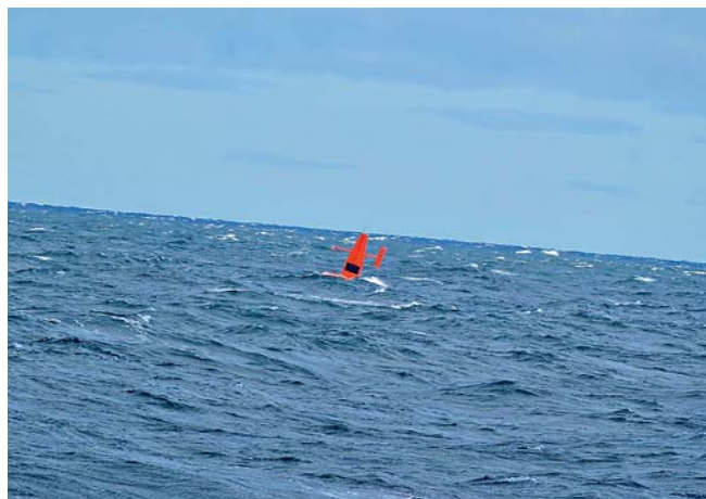
Беспилотная лодка в Чукотском море (дрон, оснащенный метеорологическими и океанографическими датчиками – Ред.) / Saildrone Chukchi Sea
